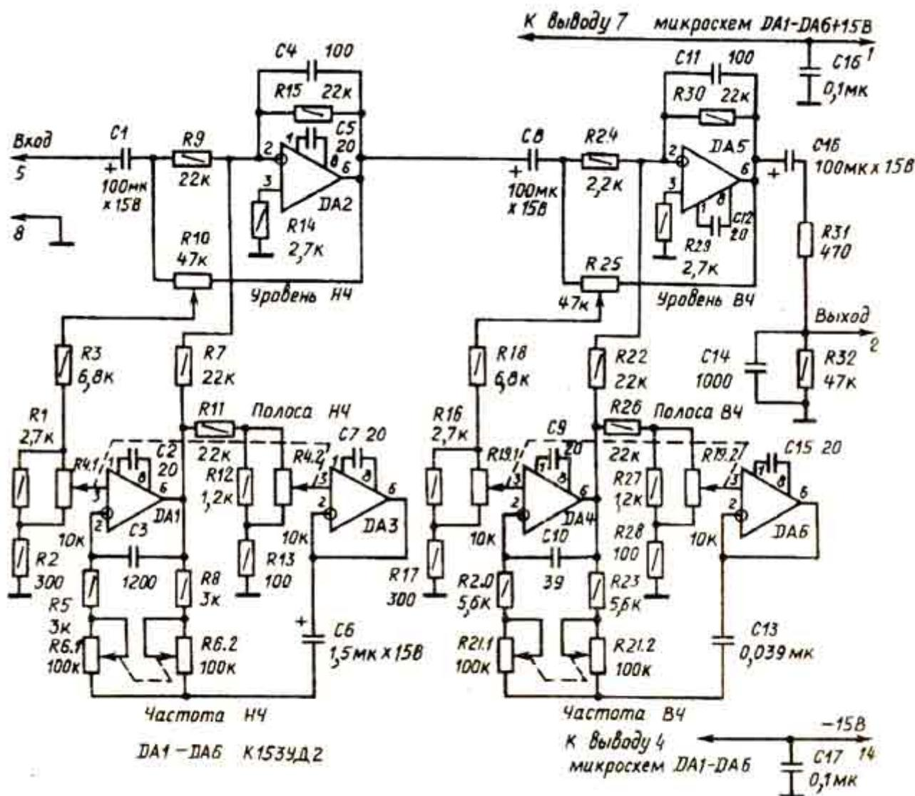
Рис. 9.17. Принципиальная схема параметрического эквалайзера на ОУ К153УД2
